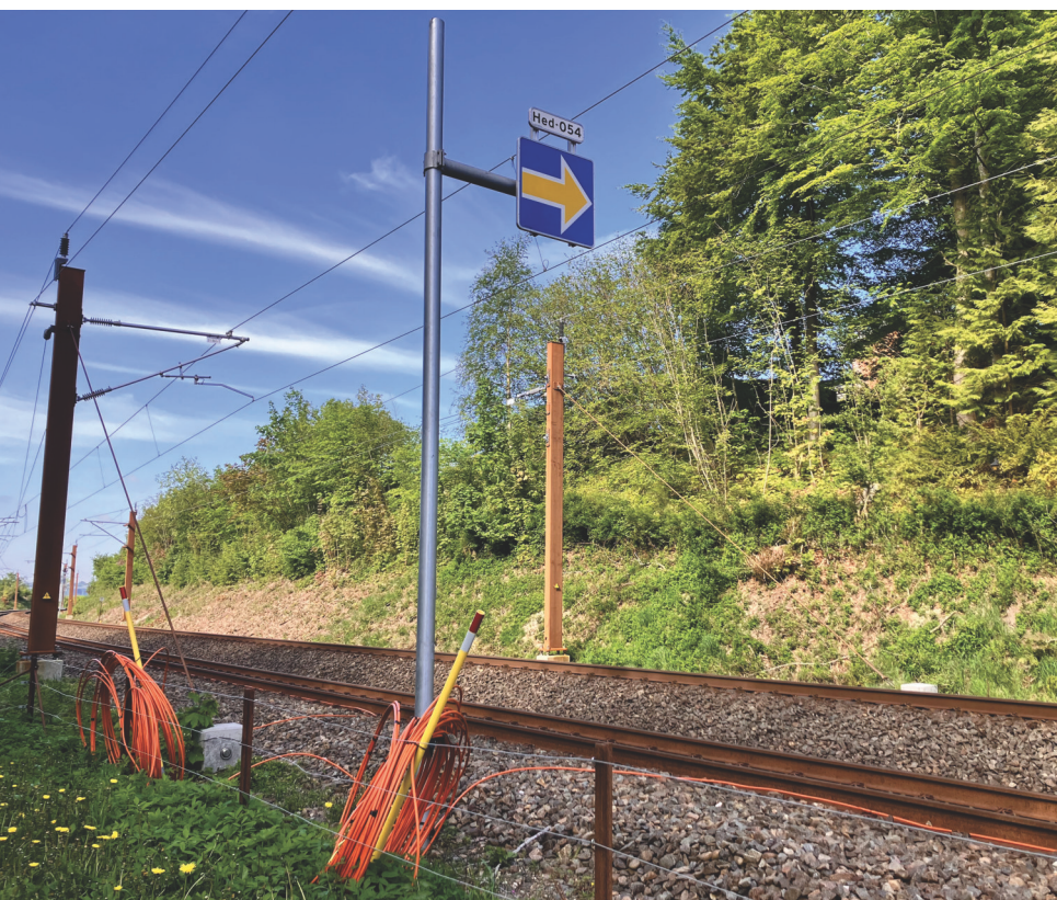
ETCS-Halttafeln Ne14 fallen auf: Bei reinen ETCS-Strecken, vor allem im Level 2, stehen sie, wie hier im Bild, allein. Bei ETCS-Strecken mit Signalen stehen sie zusammen mit diesen. Letztere Anordnung ist in der BRD künftig auf modernisierten NE-Strecken im ETCS Level 1 Full Supervision zu sehen.
